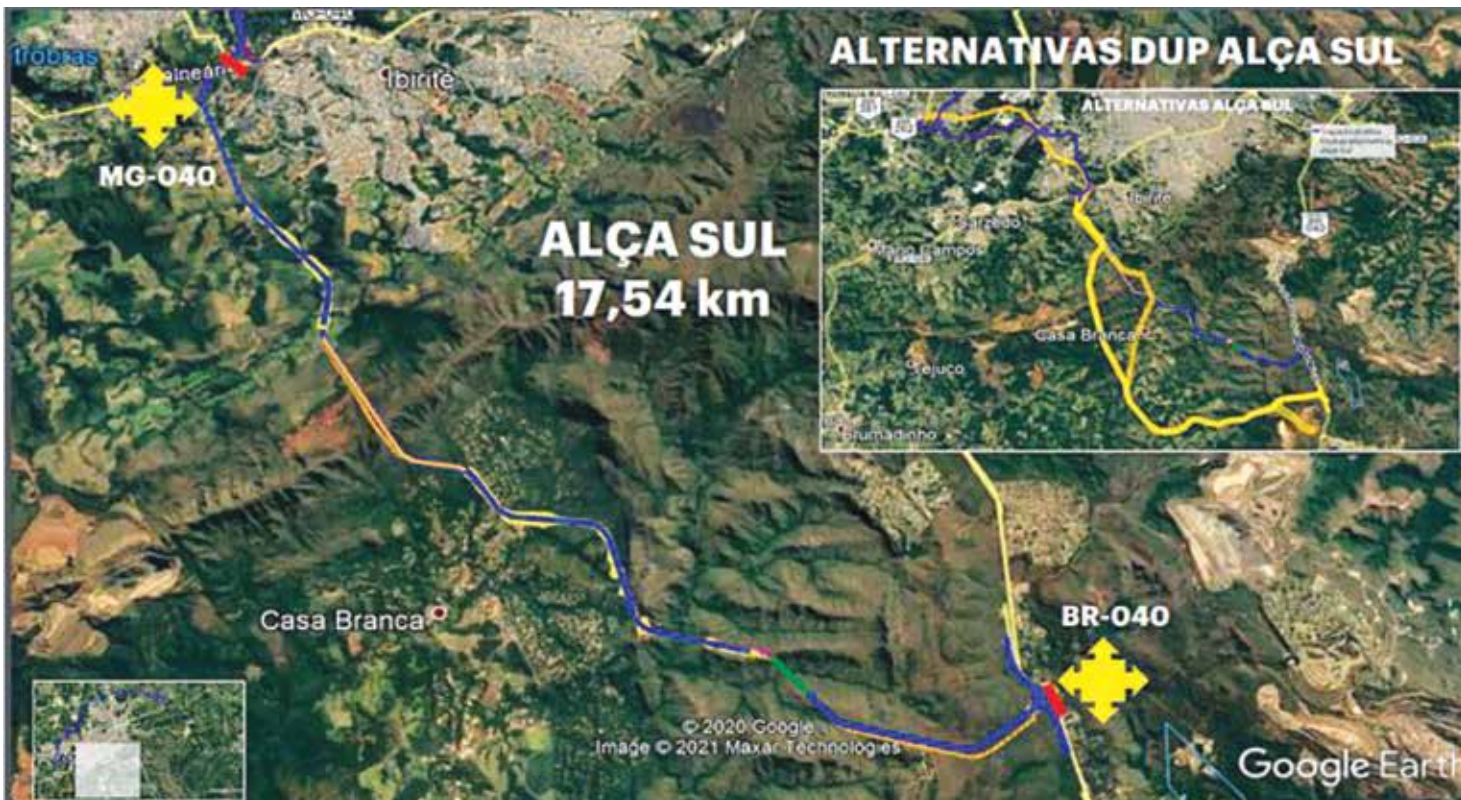
Figura 1: Proposta para Alça Sul, com 17,54 Km, ligando a MG-040 na região de Ibirité à BR-040, na saída para o Rio de Janeiro. Fonte: Doc. da audiência
