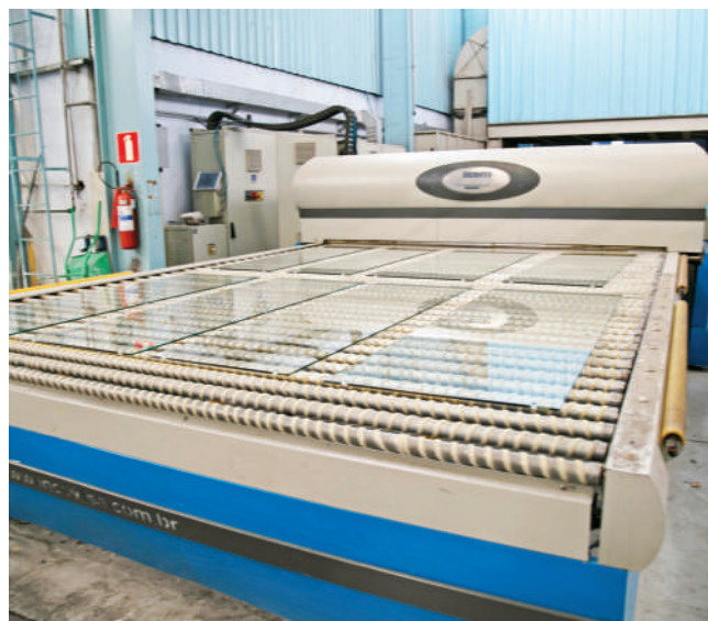
Vidro temperado em forno horizontal
